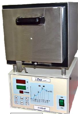
Horno de precalentamiento de cilindros con microprocesador programable hasta 50 programas. Programación de ciclos y rampas con diferentes parámetros. Capacidad de la cámara de 4,8 litros. Capacidad para 4-6 cilindros de  $\varnothing$  80 mm.
